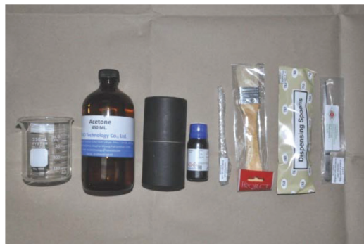
ภาพที่ ๒.๗-๑๐ อุปกรณ์ที่ใช้ในการตรวจเก็บรอยลายนิ้วมือแฝงด้วยวิธีนินไฮดริน
