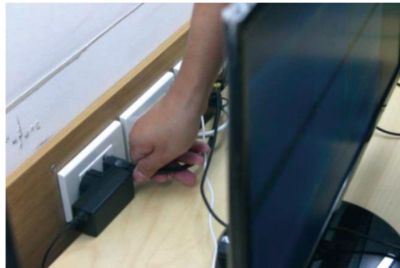
ภาพที่ ๒.๙-๕ กรณีที่สามารถเก็บข้อมูลในหน่วยความจำ RAM ได้ ให้เก็บข้อมูลในหน่วยความจำ RAM ก่อนทำการถอดปลั๊กตามภาพ
