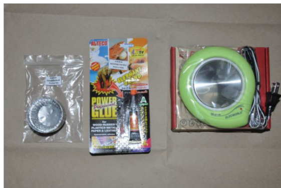
ภาพที่ ๒.๗-๑๒ อุปกรณ์ที่ใช้ในการตรวจเก็บรอยลายนิ้วมือแฝงด้วยวิธีชุบเปอร์กลู
