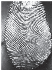
ภาพที่ ๒.๗-๑๓ รอยลายนิ้วมือแฝงที่ตรวจหาด้วยวิธี Cyanoacrylate Fuming
