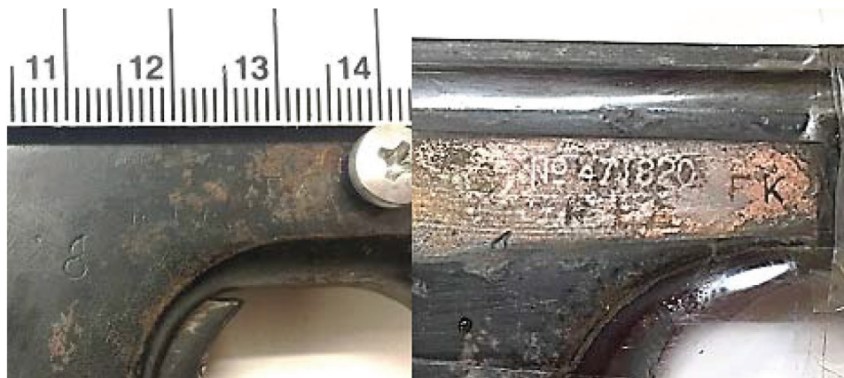
ภาพที่ ๒.๓-๗ ตัวอย่างร่องรอยขีดลบเลขหมายประจำปืนก่อนและหลังการตรวจพิสูจน์
